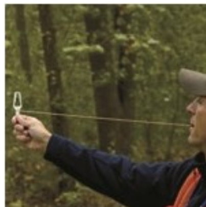
Abb. 1: Verwendetes Winkelmessblech von Ben Meadows ( www.benmeadows.com/ , Artikelbezeichnung: Ben Meadows Cruise Angle) und Methode der Anwendung (rechts)
